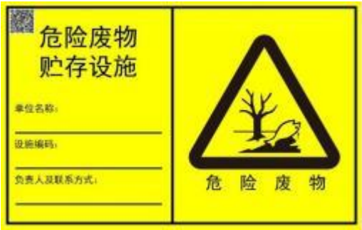
危险废物贮存库标识
